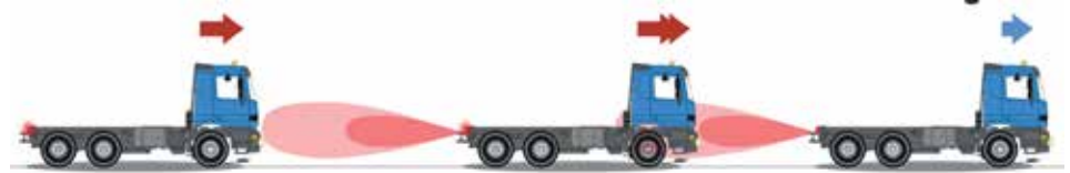
Über kleine Infrarot-Sender und -empfänger an den Fahrzeugen erkennt das „CarMotion“-System vorausfahrende Fahrzeuge und sorgt für eine vorbildgetreue vollautomatische Abstandsregelung.
